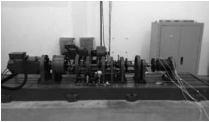
图 1 滚动轴承故障模拟试验系统
